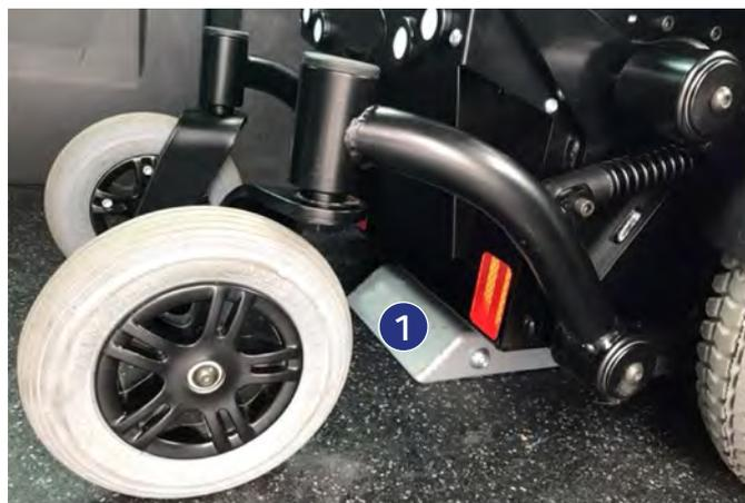
Figure 7 : ancrage automatique
